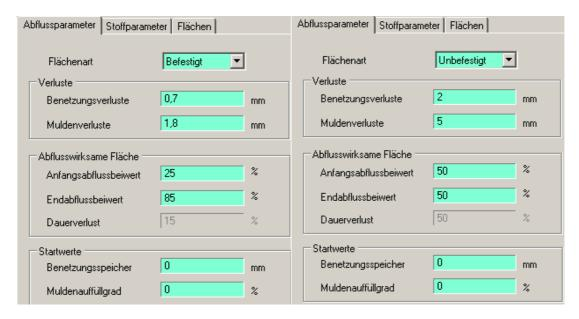
Der Endabflussbeiwert 0,85 berücksichtigt, dass bei den befestigten Flächen auch Pflaster- und Schotterflächen enthalten sind.
