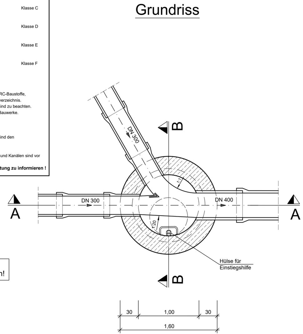
Alle Schachteinbindungen mit gelenkigem Anschluß vorsehen!
